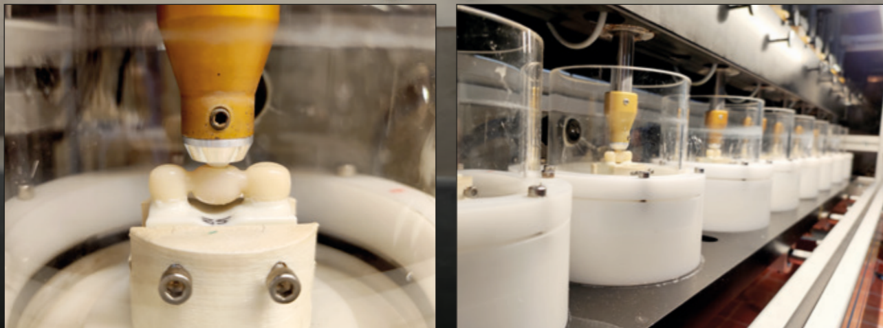
Abbildung 6 und 7: Versuchsaufbau der Kausimulation für langzeitprovisorische Brücken
