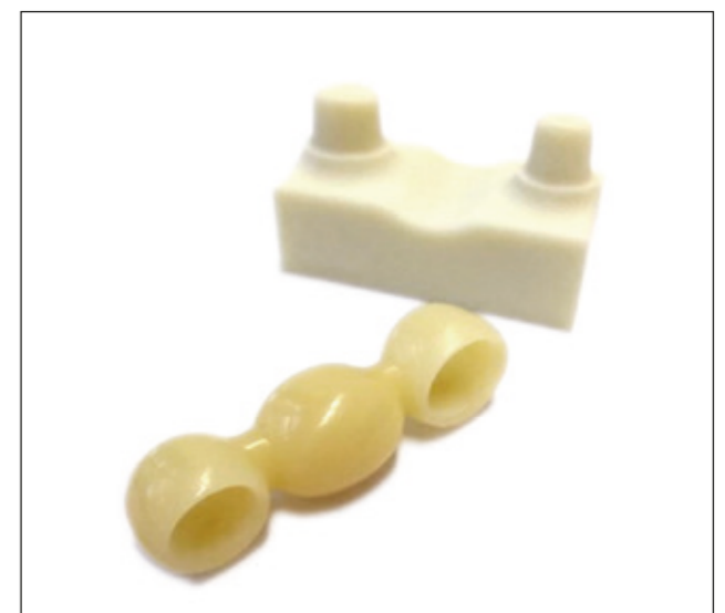
Abbildung 8: Prüfkörpergeometrie für die Kausimulation
