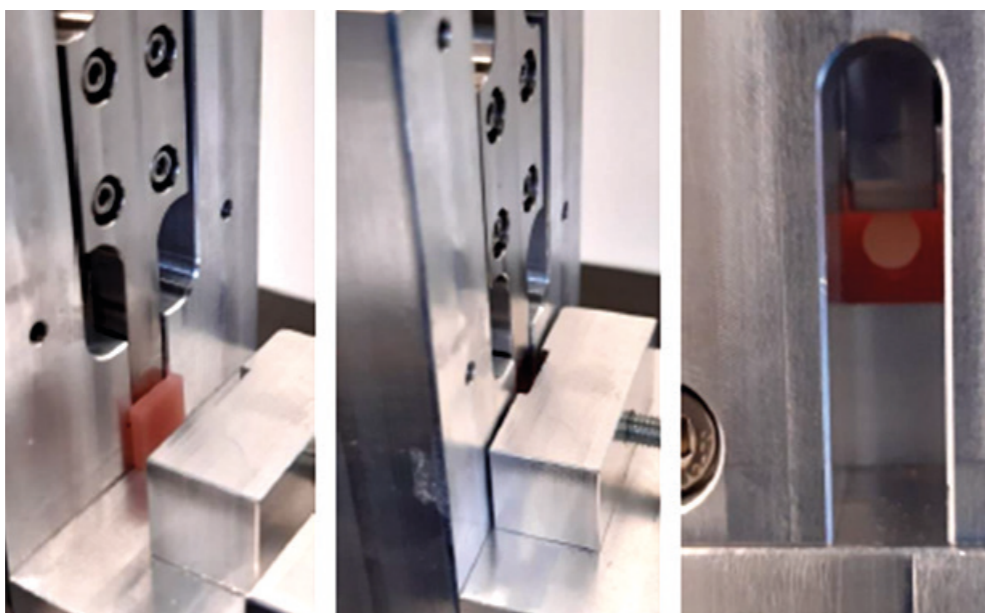
Figura 18: Diseño de ensayo para medir la fuerza de adherencia entre la prótesis y el diente protésico
