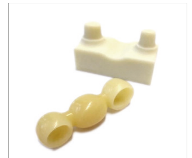
Figura 8: Geometría del objeto de ensayo para la simulación de masticación
