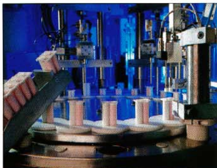
Abb. 2: Abfüllmaschine eines A-Silikons im Kartuschensystem
